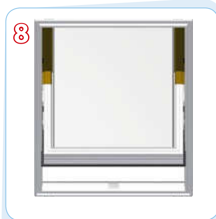
Poloha na umývanie. Krídlo otočené o 120°.
