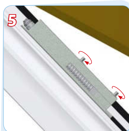
Regulácia sily otvárania a polohy zaistenia okna (max. 1 otočenie naraz).
